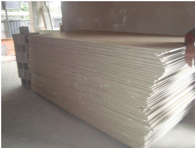
Estoque de Material (Placas de Gesso Acartonado)
